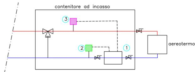
schema installazione sistema completo di regolazione e contabilizzazione.
